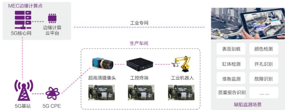
图 3-4: 基于 5G 的高精度在线检测
